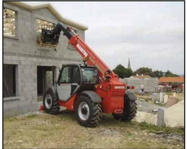
I carrelli a braccio telescopico sono attrezzature semoventi dotate di uno o più bracci snodati, telescopici o meno, non girevoli, utilizzate per movimentare carichi ed azionate da un operatore a bordo su sedile.
