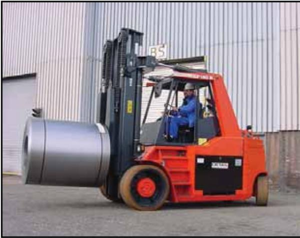
Il carrello elevatore (chiamato anche muletto) è un mezzo operativo dotato di ruote e azionato da motori elettrici, diesel e a gas, che viene usato per il sollevamento e la movimentazione di merci all'interno dei depositi di logistica o per il carico e scarico di merci dai mezzi di trasporto.
