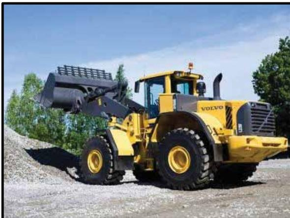
Sono macchine semoventi, impiegate prevalentemente in attività edilizia o di genio civile, adibite all'esecuzione di attività di scavo, carico e trasporto di terra o di materiali assimilati, quali roccia, sabbia, ghiaia, ecc. .
