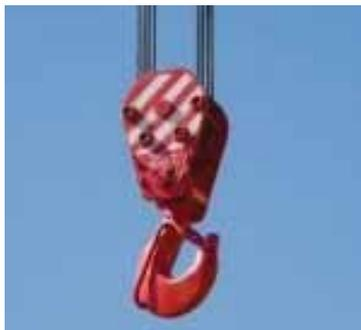
Alcuni **bozzelli** permettono di moltiplicare la capacità sollevamento con l'utilizzo una serie di pulegge in maniera da aumentare le funi coinvolte nel sollevamento; in particolare si può ottenere il tiro in seconda o il tiro in quarta. Il passaggio dal tiro in seconda al tiro in quarta può avvenire in diversi modi, manualmente o automaticamente.
