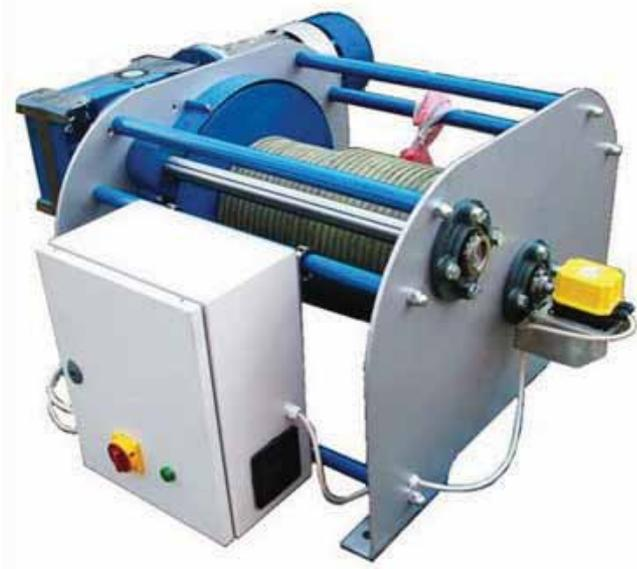
Gli argani consentono il sollevamento dei carichi mediante l'avvolgimento delle funi attorno a un cilindro rotante, con azionamento motorizzato.
