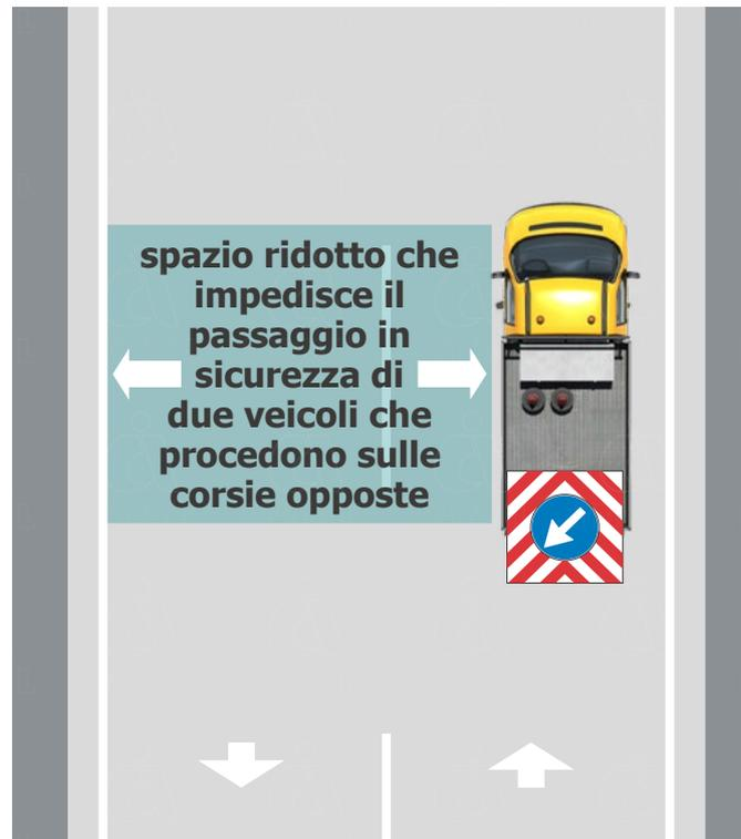
Il secondo esempio, invece, illustra il metodo e la sequenza delle azioni che devono essere adottate per la strada con larghezze tali da permettere il passaggio di due veicoli che procedono in modo opposto tra loro in presenza dei veicoli operativi.
