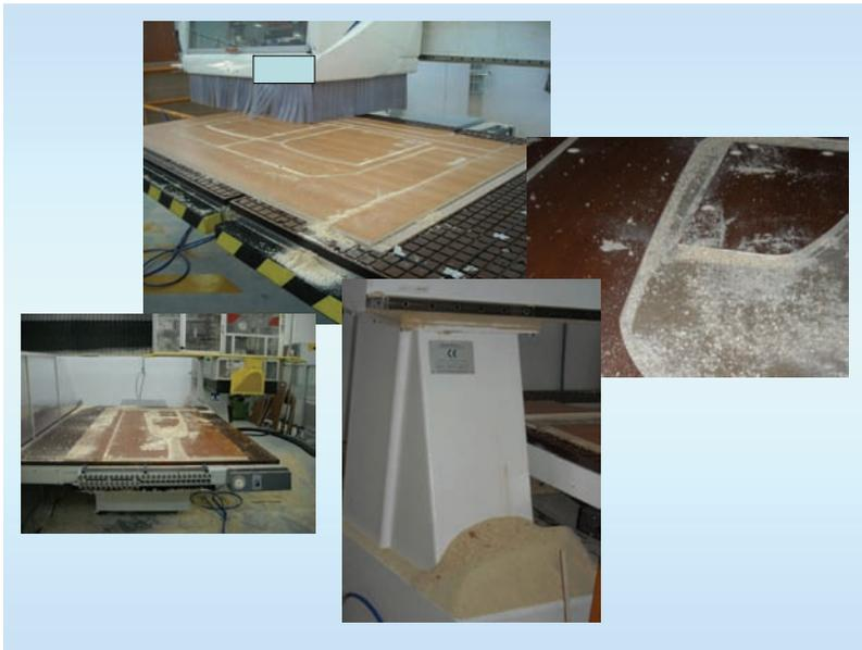
**Fig. 7:** polveri e trucioli sui pezzi lavorati e uso di aria compressa per la pulizia
