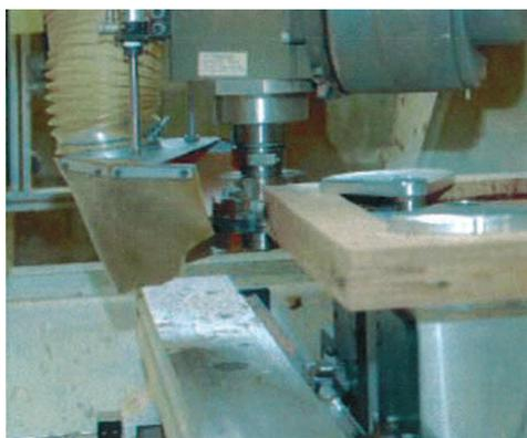
La grande varietà di operazioni rende difficoltosa la captazione dei trucioli. La direzione del punto di generazione e proiezione della polvere varia secondo l'utensile, il senso di rotazione e la modalità di lavoro. Le soluzioni tradizionali o sono insufficienti a causa della incompleta recinzione dell'area da proteggere oppure non tengono conto della direzione di proiezione.
