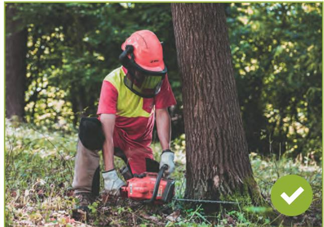
Durante le operazioni di taglio va mantenuta la posizione maggiormente ergonomica: la schiena dritta permette inoltre di controllare meglio la direzione di taglio.
