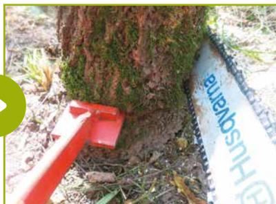
Il taglio di abbattimento viene completando tagliando il diametro residuo ( $1/4$ ) con un taglio a catena traente lungo un piano inclinato che, rispettando la cerniera, deve incrociare il taglio orizzontale di abbattimento.
