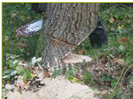
Il taglio di abbattimento va eseguito a metà dell'altezza della tacca di direzione, perpendicolare all'asse del tronco. Va eseguito orientando subito la spranga nella direzione di caduta al fine di tagliare il legno in tensione in modo omogeneo.
