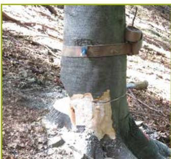
Il taglio di abbattimento va eseguito ad una altezza pari allo spessore iniziale della cerniera; questo taglio deve essere ortogonale all'asse del tronco.
