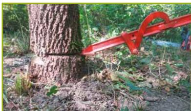
A questo punto si inserisce bene nel taglio di abbattimento parziale la leva di abbattimento. In alternativa può essere usato il cuneo di abbattimento.
