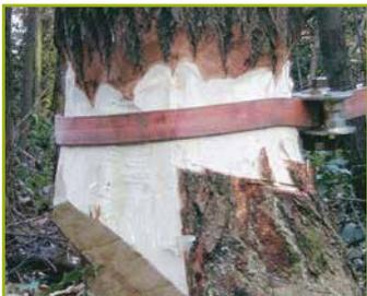
Se necessario, qualora le tensioni siano elevate e la specie è predisposta a spaccature, bisogna montare il serratronchi.
