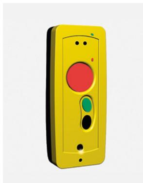
Apparecchio per la sorveglianza di persone con controllo della posizione del corpo. Tasto manuale per chiamata di emergenza.
