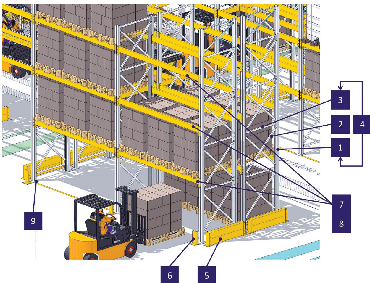
Figura A-3: Scaffalature porta pallet: denominazione componenti principali
